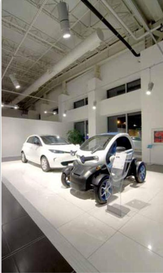
Satış alanında yer alan diğer Renault otomobillerinin aydınlatmasında da, ışığın otomobilin üstünde patlamasına mahal vermeden özellikle yan taraflardan otomobilin parlamasını sağlayacak bir armatür yerleşimi yapılmış ve yine özel üretim 2x40W LED sarkıtlar kullanıldı. Çok geniş bir alana yayılan bayide, müşterilerin rahatça dolaşabilecekleri ve 2x20W LED sarkıtların kullanıldığı koridor alanlarının aydınlık düzeyi, diğer mekanlardan daha düşük tutuldu.
