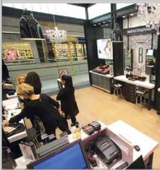
Clinique mağazasında duvar teşhirlerinde 30W LED lambalı, 45 derece reflektörlü, 4000K – CRI>90 ankastre yönlendirilebilir armatürler kullanılırken, aralarda 12W LED lambalı 30 derece reflektörlü, 3000K – CRI>90 ışık rengine sahip armatürlere de yer verildi. Böylece, hem duvar ünitelerinin önündeki renk algısı netleştirildi, hem de uygun ışık düzeyi ile ışık patlamalarının önüne geçildi.
